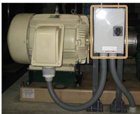
Gráfico 6-11 Ejemplo: Dispositivo para la eliminación de energía para prevenir una puesta en marcha inesperada
